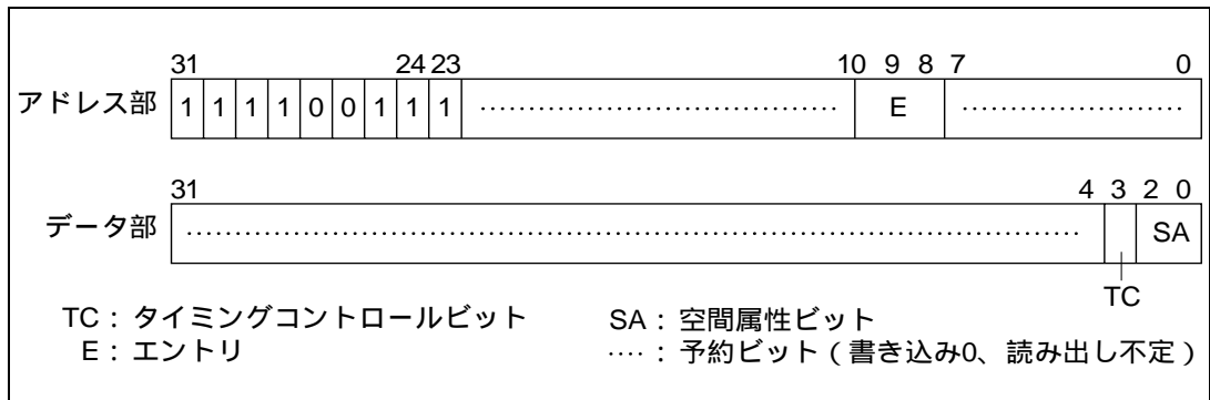
図 3.15 メモリ割り付け ITLB データアレイ 2
