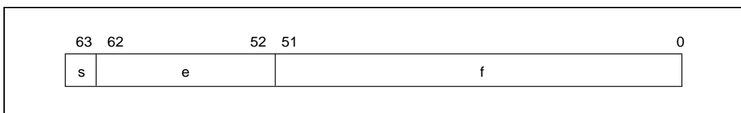
図 6.2 倍精度浮動小数点フォーマット
