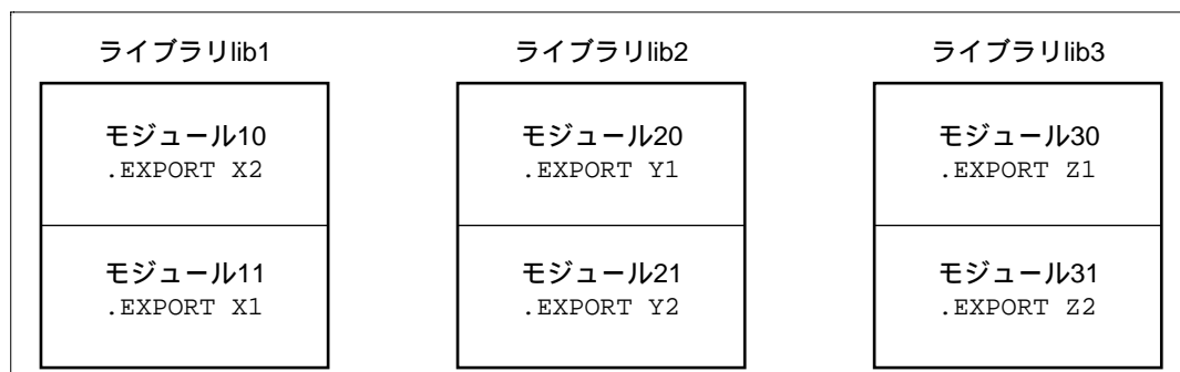
図 2.12 モジュール結合の例 (入力ライブラリファイル)
